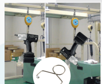
Horizontale und vertikale Geräteaufhängung ist möglich
