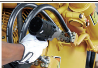
Flexibel einsetzbar, da keine Drehmomentabstützung benötigt wird
